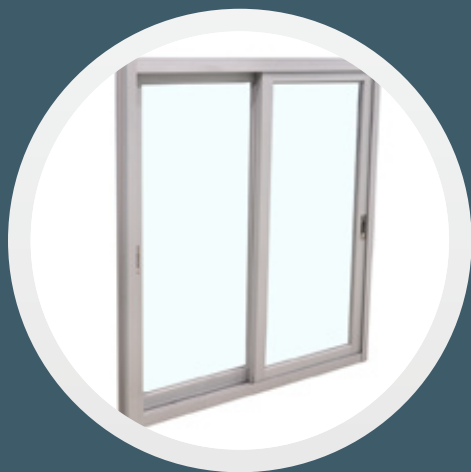
OSP-SSW10*1-SL. VENTANA DE ALUMINIO CORREDIZA, doble vidrio de seguridad, sistema 5mmx6Ax5mm, espesor del perfil 1.4mm color gris, pintura en polvo.
