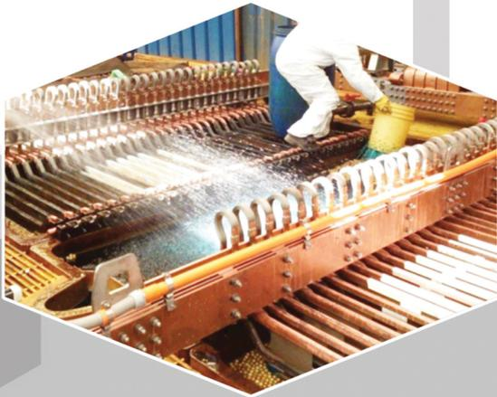
Con el objetivo de cortocircuitar dos celdas de electro obtención que se encuentran al interior del Marco Cortocircuitador, sin detener la planta de EW, el equipo permite mantener y desbarrar las celdas sin interrumpir el proceso.
