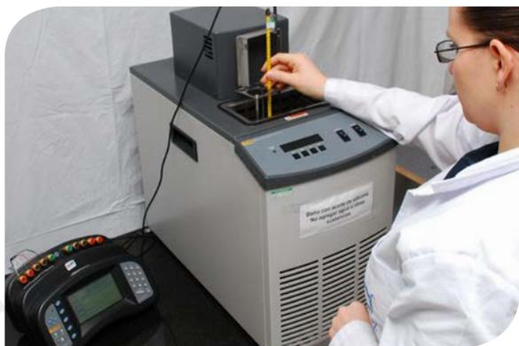
Calibración de termómetros líquido en vidrio, RTD, termopares, termómetros bimetálicos, infrarojos y otros.
