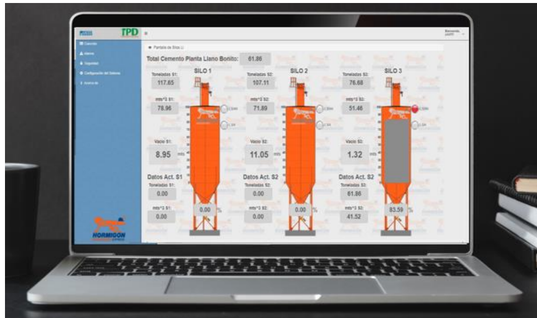
CONTROL DE VARIABLES Y GENERACION DE REGISTROS HISTORICOS EN SILOS DE CONCRETO
