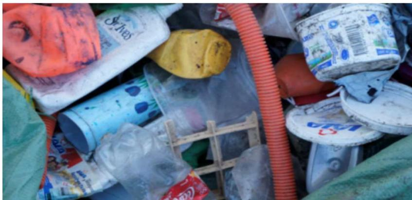
La naturaleza del proceso permite usar casi cualquier termoplástico, (MATERIA PRIMA) sin embargo las mejores opciones para un tablero fácil de maquinar y resistente son los polietilenos de alta densidad y los polipropilenos.
