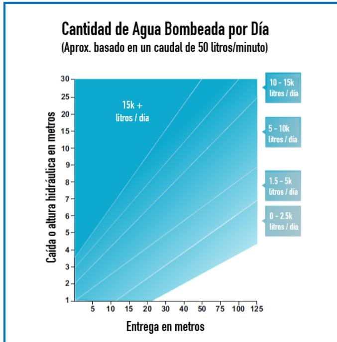
La distancia bombeada depende de la fricción del tubo y de la altura de entrega. Consulte las tablas de fricción de tubo del fabricante respectivo. De requerirse más bombeo de agua, es posible la instalación de múltiples bombas.
