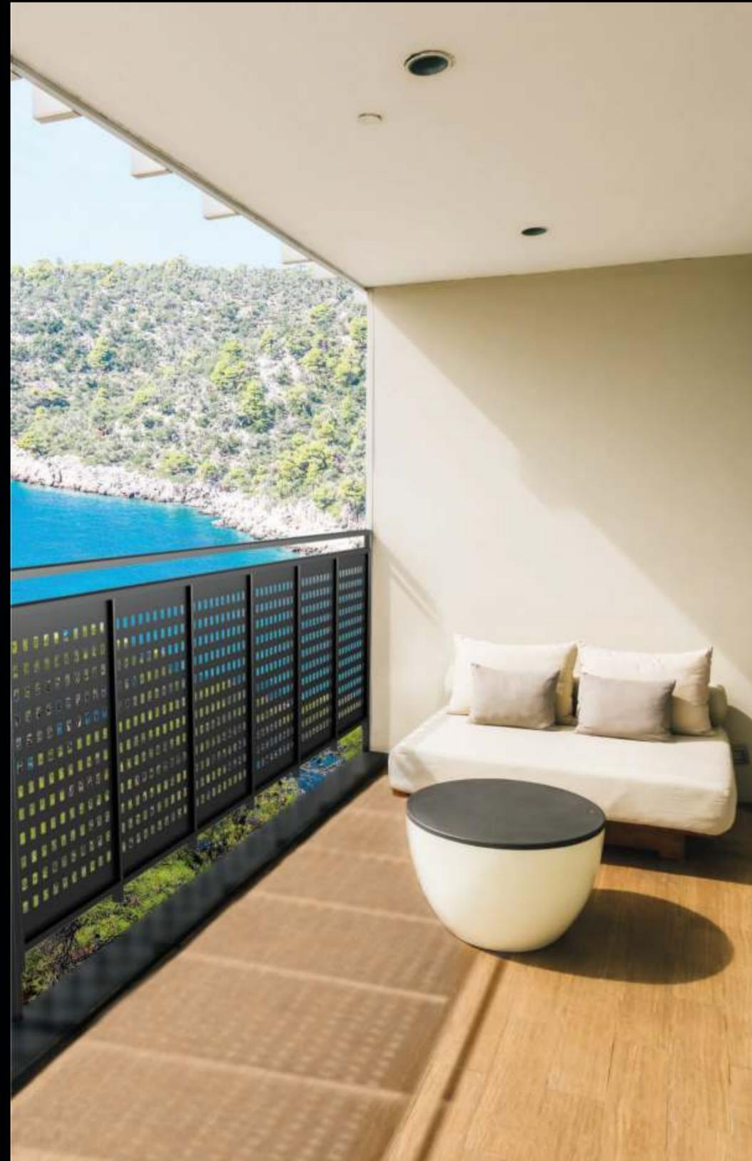
Elaborados en lámina metálica con diseños en corte por láser y punzonado. Acabados industriales con pintura electrostática.
