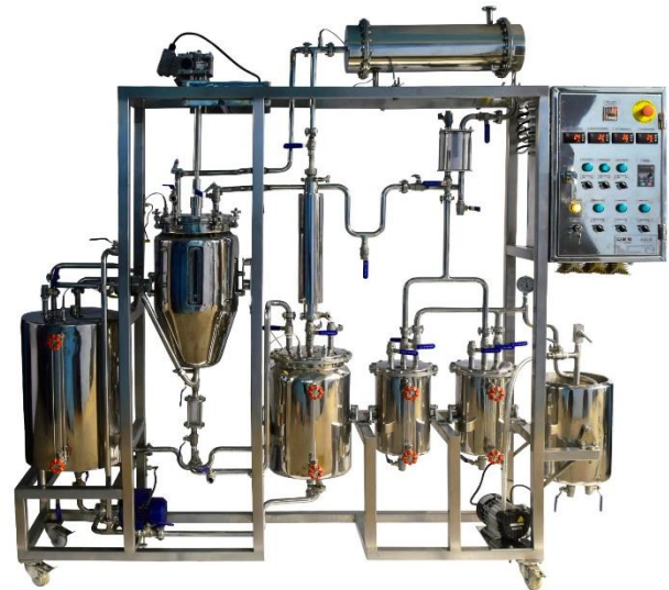
Planta de extracción sólido líquido
