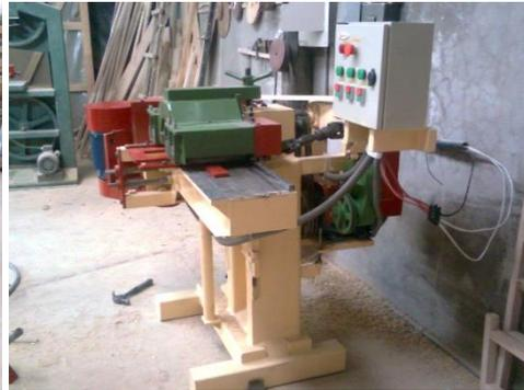
**CEPILLADORA MACHIHEMBRADORA. Modelo CM-150**
