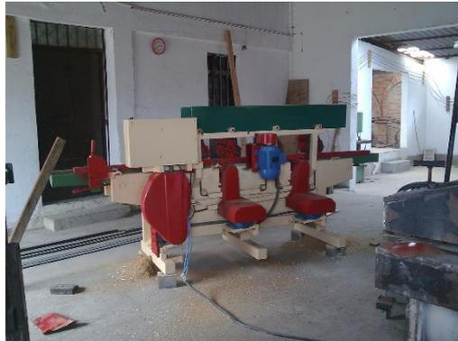
**CANTEADORA DOBLE AUTOMATICA CODALADORA. Modelo CDA-300**
