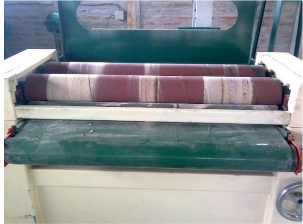
**LIJADORA DE RODILLOS HORIZONTAL. Modelo LR-600**
