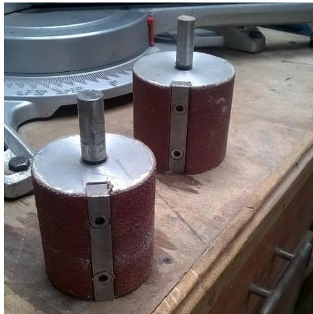
**CILINDROS DE LIJADO. Modelo CLT - 4**
