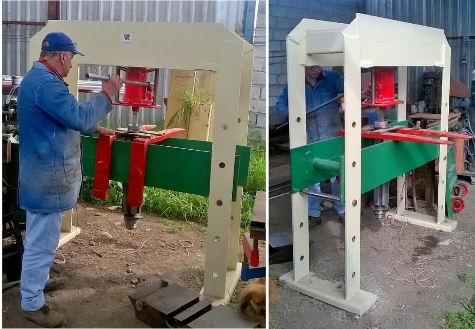
**PRENSA HIDRÁULICA PARA MECÁNICA. Modelo PHM-50**
