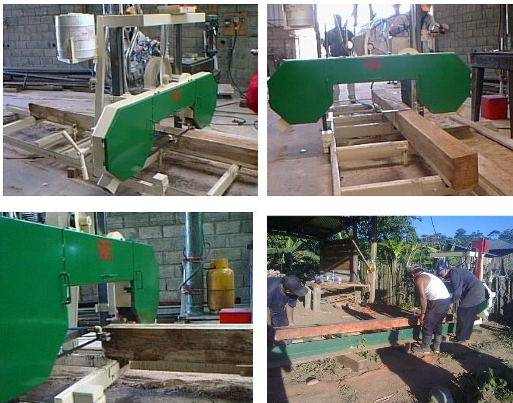
**ASERRADERO DE CABEZA HORIZONTAL TRANSPORTABLE. Modelo HCH-15**
