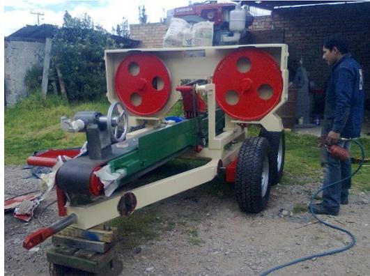
**SIERRA CINTA HORIZONTAL REASERRADOR TRANSPORTABLE. Modelo SCR-720**
