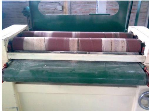
**LIJADORA DE RODILLOS HORIZONTAL. Modelo LR-1.200**
