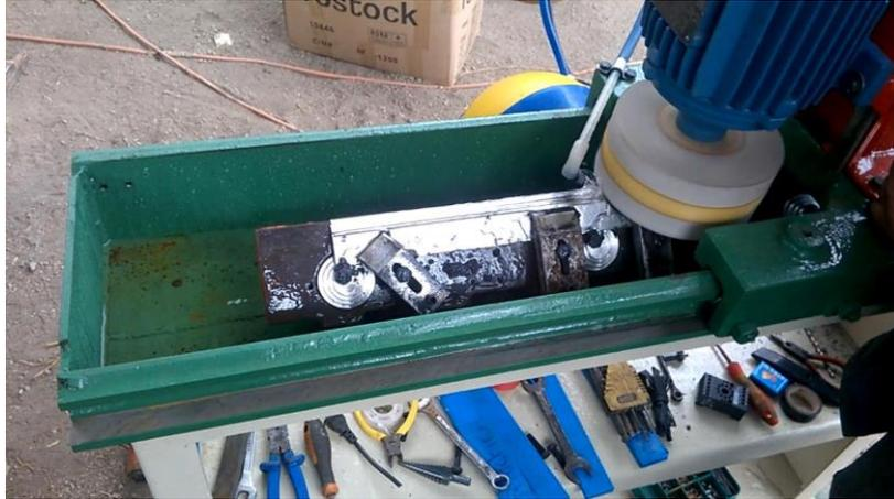
**AFILADORA DE CUCHILLAS DE CEPILLADORA. Modelo ACC-600**
