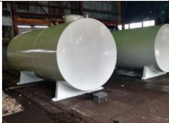
Acabado con pintura a base de Poliuretano
