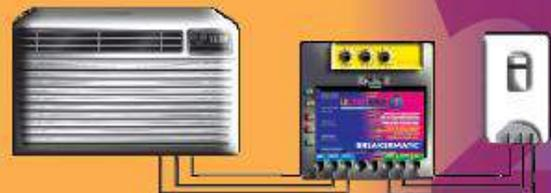
Identifique los cables de "FASE" que vienen del breaker y conéctelos en donde dice "ENTRADA". Identifique los cable que van al equipo a proteger y conéctelos donde dice "SALIDA".
