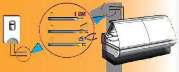
Coloque "firmemente" los terminales suministrados a los cables de la alimentación.
