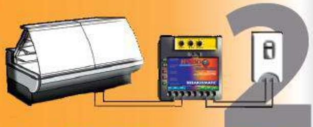
Identifique la "FASE" y el "NEUTRO" en los cables que vienen del breaker con un comprobador de voltaje ( la "FASE" lo enciende, el "NEUTRO" y la "TIERRA" no) y conéctelos en la regleta donde dice "ENTRADA". Identifique los cable que van al equipo a proteger y conéctelos donde dice "SALIDA".
