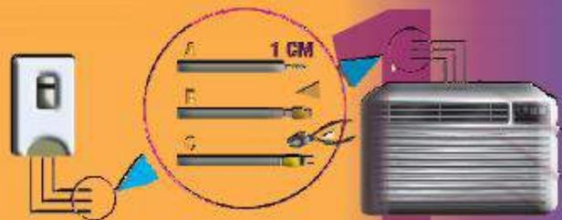
Coloque "firmemente" los terminales suministrados a los cables de la alimentación
