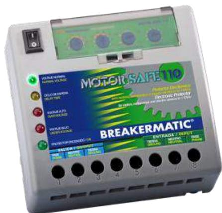
El **BREAKERMATIC Motor Safe 110** está diseñado para evitar los daños a sus equipos motores de 110V, provocado por las variaciones de voltaje. Cuenta en la parte frontal con 4 perillas de ajuste para voltaje de corte alto y bajo, la duración del ciclo de espera, el tiempo de retardo entre la detección de la falla y la desconexión de la salida; y un suiche de encendido y apagado del protector.
