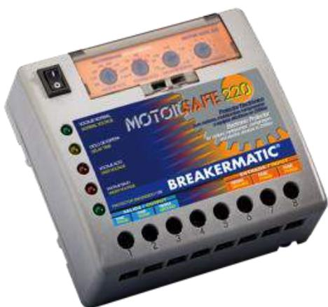
El **BREAKERMATIC Motor Safe 220** está diseñado para evitar los daños a sus equipos motores en 220V, provocado por las variaciones de voltaje. Cuenta en la parte frontal con 4 perillas de ajuste para voltaje de corte alto y bajo, la duración del ciclo de espera, el tiempo de retardo entre la detección de la falla y la desconexión de la salida; y un suiche de encendido y apagado del protector.
