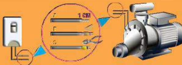
Coloque "firmemente" los terminales suministrados a los cables de la alimentación.
