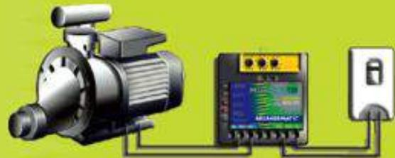
Identifique la "FASE" y el "NEUTRO" en los cables que vienen del breaker con un comprobador de voltaje ( la "FASE" lo enciende, el "NEUTRO" y la "TIERRA" no) y conéctelos en la regleta donde dice "ENTRADA".
