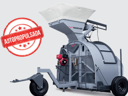
INGRAIN200 EMBOLSADORA DE GRANOS Embolsadora de granos autopropulsada con capacidad de 400 ton/h. Neumáticos 31x10.5” Aro 15. Frenos a disco y cabestrante eléctrico para el levantamiento de la bolsa de 9 pies. Motor de gasolina 15 CV con ignición manual.
