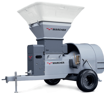
INGRAIN60 GRANOS HÚMEDOS EMBOLSADORA DE GRANOS HÚMEDOS Embolsadora para granos húmedos con capacidad de 20 ton/h para bolsa de 6 pies. Neumáticos 31x10.5” Aro 15. Frenos a disco. Accionamiento TDP 540 RPM, tractor 75 CV.
