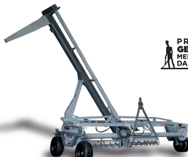
OUTGRAIN215 EXTRACTORA DE GRANOS Extractora de granos con capacidad de 180 ton/h. Neumáticos 235/75 Aro 15. Accionamiento TDP 540 RPM, tractor 75 CV. Transmisión mecánica.
