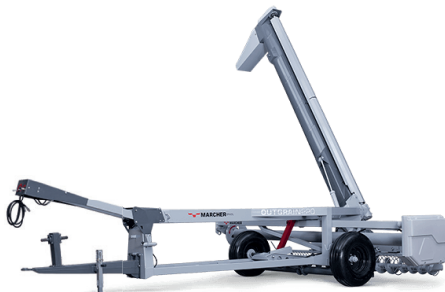
OUTGRAIN220 EXTRACTORA DE GRANOS Extractora de granos con capacidad de 300 ton/h. Neumáticos 11L15 – 12 lonas. Accionamiento TDP 540 RPM, tractor 75 CV. Transmisión mecánica.
