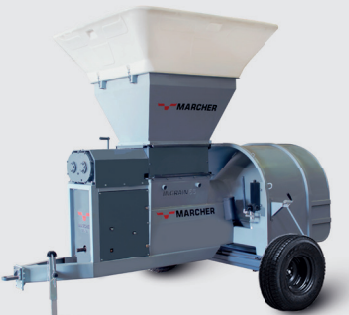
INGRAIN65 GRANOS HÚMEDOS EMBOLSADORA DE GRANOS HÚMEDOS Embolsadora para granos húmedos, con capacidad de 40 ton/h con quebrador importado, para bolsa de 6 pies. Neumáticos 31x10.5” Aro 15. Frenos a disco. Accionamiento TDP 540 RPM, tractor 75 CV. Maíz o Sorgo.
