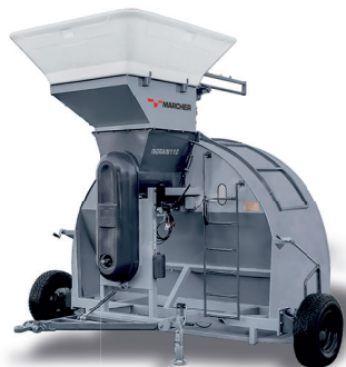
INGRAIN110 EMBOLSADORA DE GRANOS Embolsadora de granos con capacidad de 600 ton/h, siendo la mayor del mercado en Brasil. Utiliza silo-bolsa de 10 pies. Neumáticos 31x10.5” Aro 15. Frenos a disco. Cabestrante eléctrico para el levantamiento de la bolsa de 10 pies.
