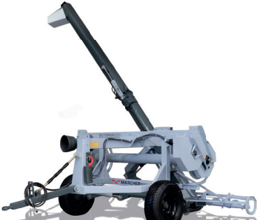
OUTGRAIN211 EXTRACTORA DE GRANOS Extractora de granos con capacidad de 100 ton/h. Accionamiento TDP 540 RPM, tractor 70 CV. Transmisión mecánica.
