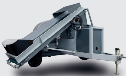
INGRAIN65 FORRAJE EMBOLSADORA DE FORRAJE Embolsadora para forraje con capacidad de 60 ton/h para bolsa de 6 pies. Neumáticos 31x10.5” Aro 15. Frenos a disco. Accionamiento TDP 540 RPM, tractor 75 CV.
