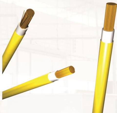
Múltiples filamentos de cobre electrolítico recocido, recubiertos por una capa interna de Policloruro de Vinilo (PVC) y una capa externa impermeable y de alta resistencia a agresiones externas. Ambas poseen tecnología anti-llama.
