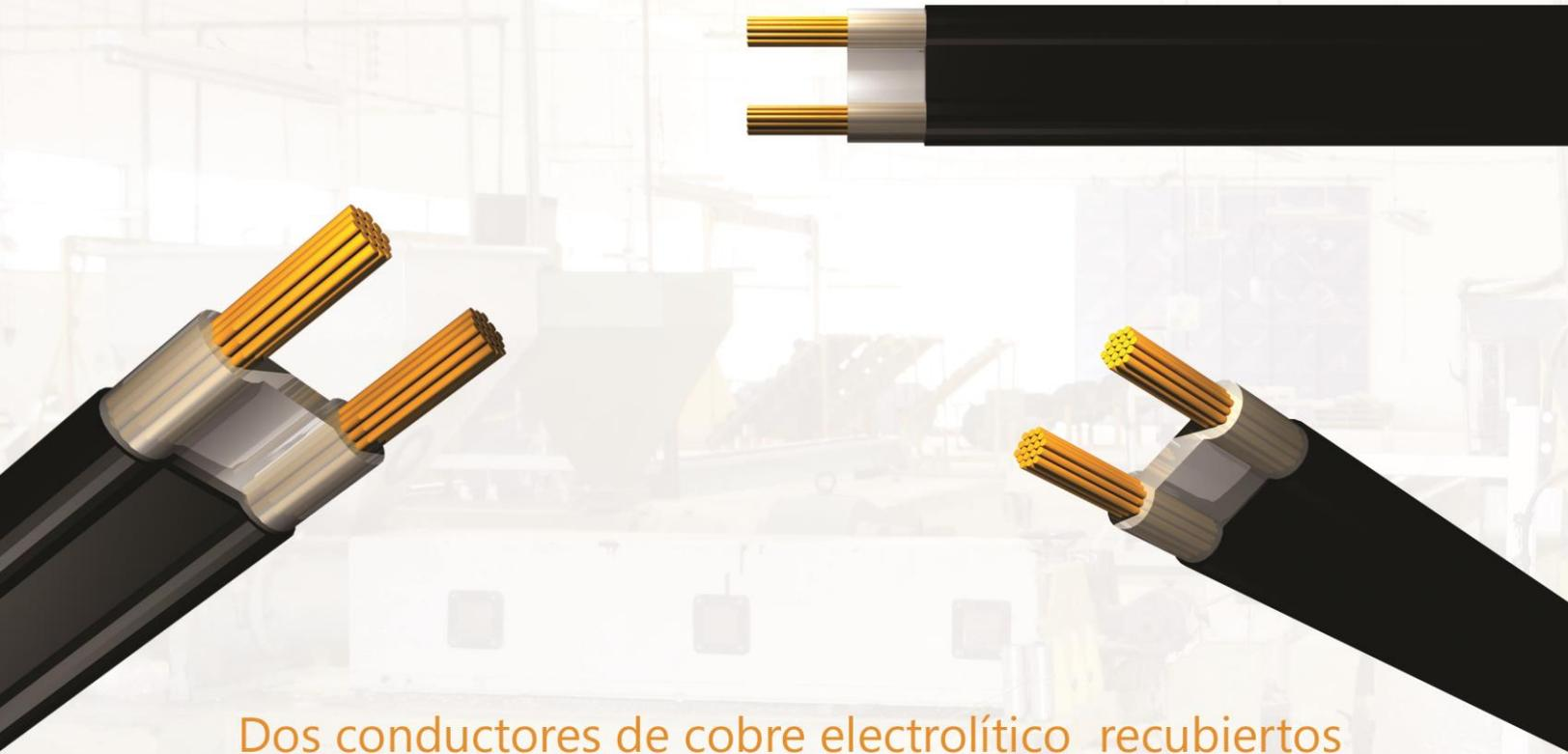
Dos conductores de cobre electrolítico recubiertos de manera paralela con aislamiento de polietileno de baja densidad natural y forrado con una capa de aislación de Policloruro de Vinilo (PVC).
