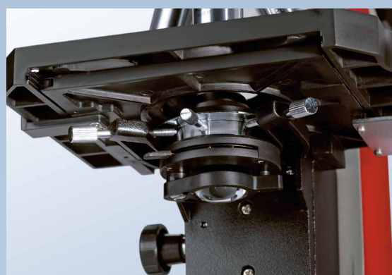
➤ Condensador Abbe con el soporte del filtro
