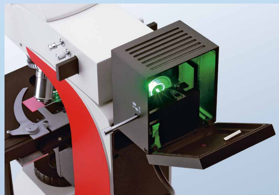
➤ Iluminación fluorescente mediante LED verde Filtro: 460 – 550 nm / 590 nm
