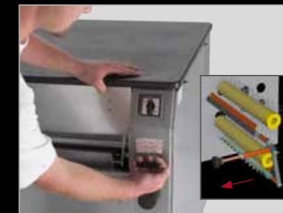
Sistema de autolimpieza para los cepillos.
